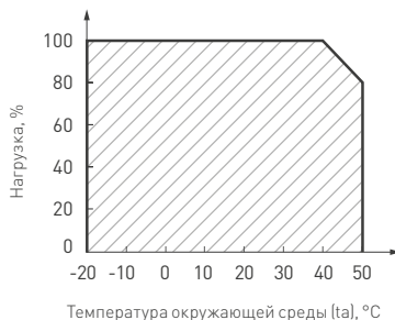
Рис. 2. Максимальная допустимая нагрузка, % от мощности источника
