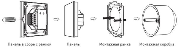
Рис. 2. Монтаж панели
