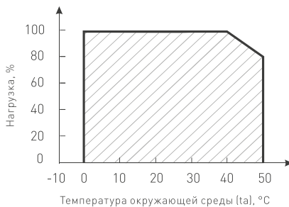
Рис. 2. Максимальная допустимая нагрузка, % от мощности источника
