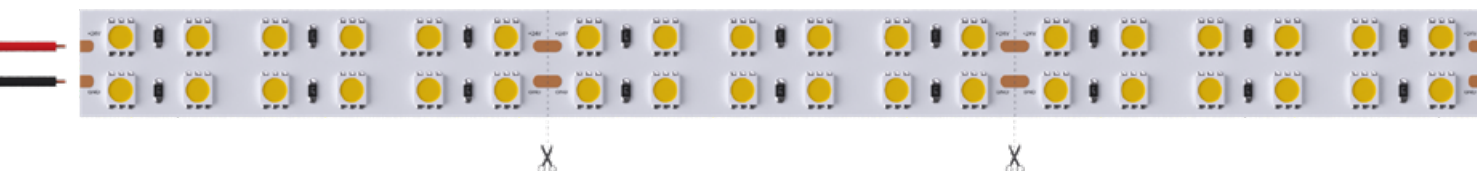
Схема 1: подключение нескольких светодиодных лент с одной стороны
