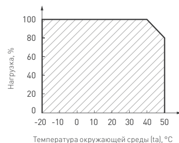
Рис. 2. Максимальная допустимая нагрузка, % от мощности источника
