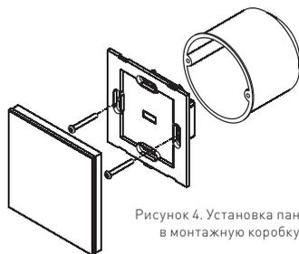
Рисунок 4. Установка панели в монтажную коробку
