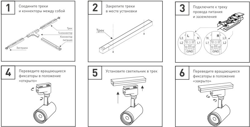
Рисунок 2. Установка и подключение светильника
