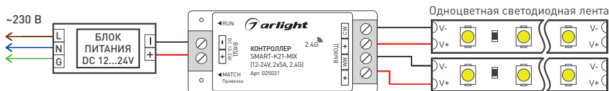
Рис. 2. Подключение одноцветной светодиодной ленты. Ленты управляются синхронно.
