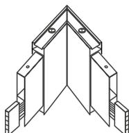
Соединительный угол 60° со светодиодным модулем, светоизлучение в нижнюю полусферу.
