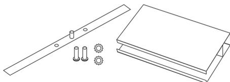
Прямой коннектор в комплекте с соединительной платой.
