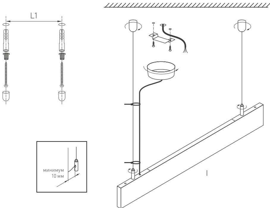
Рис. 2. Подключение и крепление одиночного светильника
