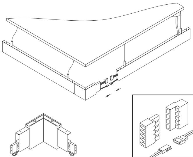
Рис. 4. Соединение светильников с использованием угловых соединителей
