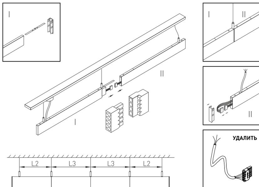
Рис. 3. Соединение светильников в линию
