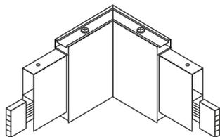
Соединительный угол 90° со светодиодным модулем, светоизлучение в нижнюю полусферу.
